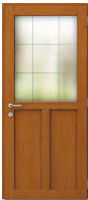
EXTÉRIEUR ALUMINIUM Couleur noir 2100 sablé. Moulures rapportées. Double ou triple vitrage retardateur d'effraction. Option vitrage pix arena. Option petit-bois plomb intégrés. INTÉRIEUR BOIS Finition chêne moyen. Ud \geq 1,4 \text{ W/m}^2.K // Ud triple vitrage \geq 1,0 \text{ W/m}^2.K
