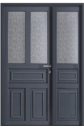
MAVS - Double vitrage retardateur d'effraction delta maté extra clair (10P5 TBE/18/4 DMX argon)
